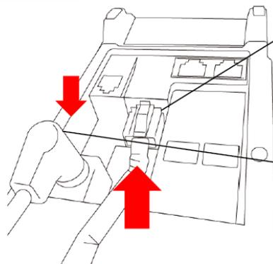
(1) 端末本体部の裏面にLANケーブルを接続します。
